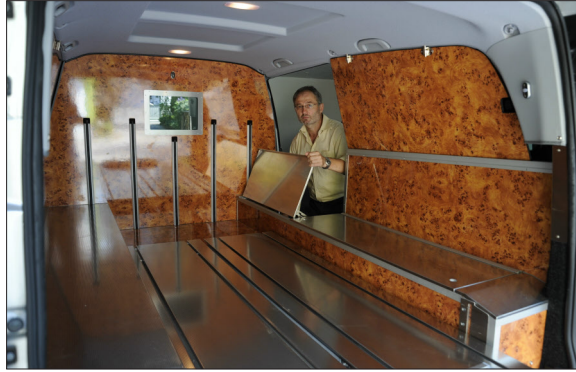
Heute nutzen Martin Erhard und seine Kollegen solche Transporter. Hydraulik und Schlitten helfen beim Ein- und Ausladen der Särge. – Foto: Binder
